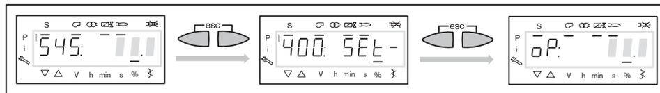
**24. Корректировка положения воздушной заслонки на предварительной продувке**
