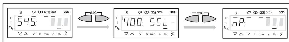
**24. Корректировка положения воздушной заслонки на предварительной продувке**
